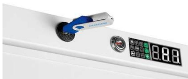
Il pannello di controllo della serie SR ha tutto quello che potresti desiderare da un frigorifero per farmaci: registratore di temperatura standard con scaricamento dei dati tramite USB; controllo superiore agli standard: controllo preciso a 0,1°C e e numerosi allarmi. Tutti i dettagli nella esauriente tabella dati seguente.
